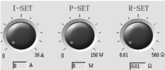
图2-7旋钮设置电流，功率，电阻
