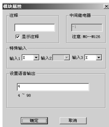
图 3.24 语音播放、录制模块属性的设置
