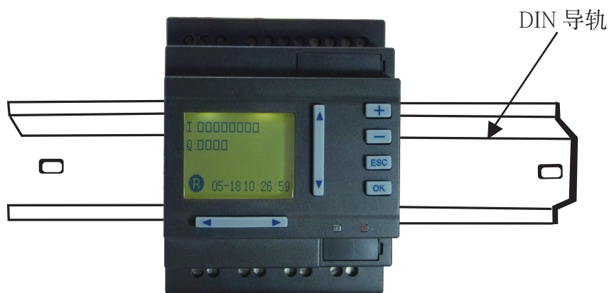
图 2.1 采用DIN轨道安装APB
